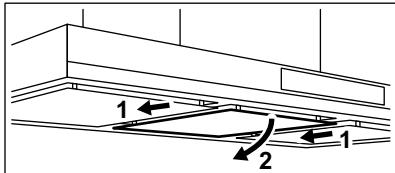
2. Kallista suodattimen etuosaa hiukan alas päin ja vedä sen jälkeen.
