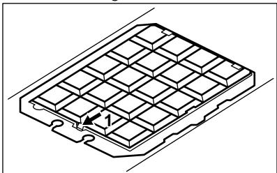
3. Utför proceduren i omvänt ordning när du ska installera ett nytt filter. Under alla omständigheter måste filtren bytas minst var fjärde månad.
