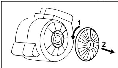
Při instalaci filtrů zpět proveděte stejný postup v opačném pořadí.
