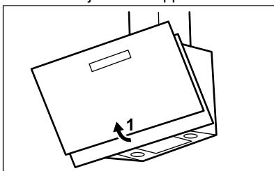
2. Tryck ner handtaget på monteringsklämman på filterpanelen under fläkten (1).
