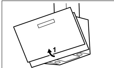
2. Trykk på håndtaket til monteringsklipsen på filterpanelet under ventilatoren (1).
