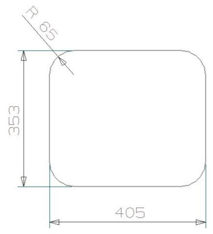
Colorado Uitsparing blad onderbouw spoelbak Aussparung Platte Unterbau Spule Cut out worktop underbuild sink
